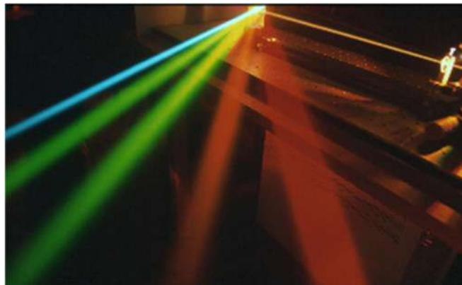
**Fig. VI. 25 :** Génération de fréquences visibles dans un cristal non linéaire (oscillateur paramétrique optique).
