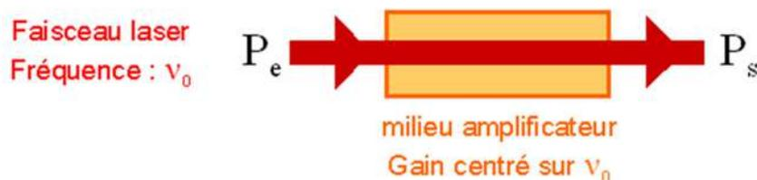
**Fig. VI. 13 :** Puissance en entrée et en sortie du milieu amplificateur.
