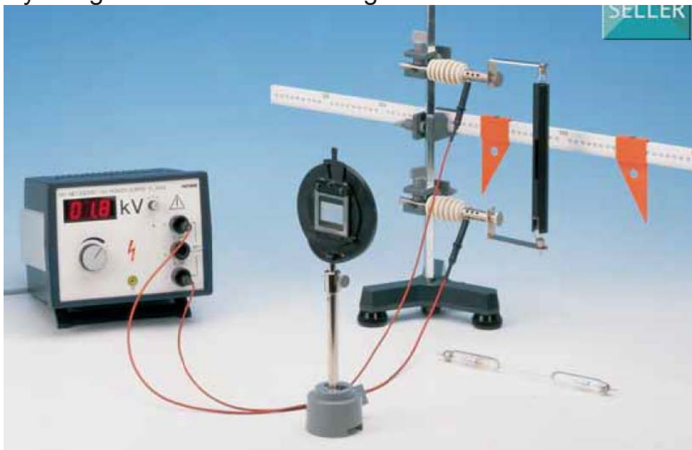
Fig. 1: Montage Séries de Balmer / Détermination de la constante de Rydberg
