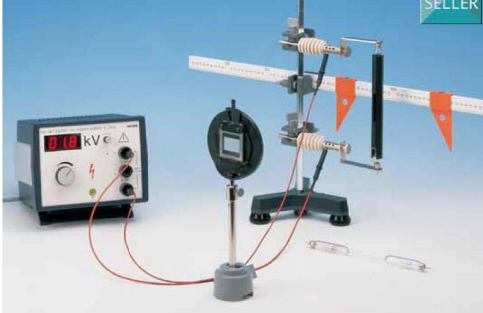
Fig. 1: Montage pour la mesure des spectres de l'He et de l'Hg.
