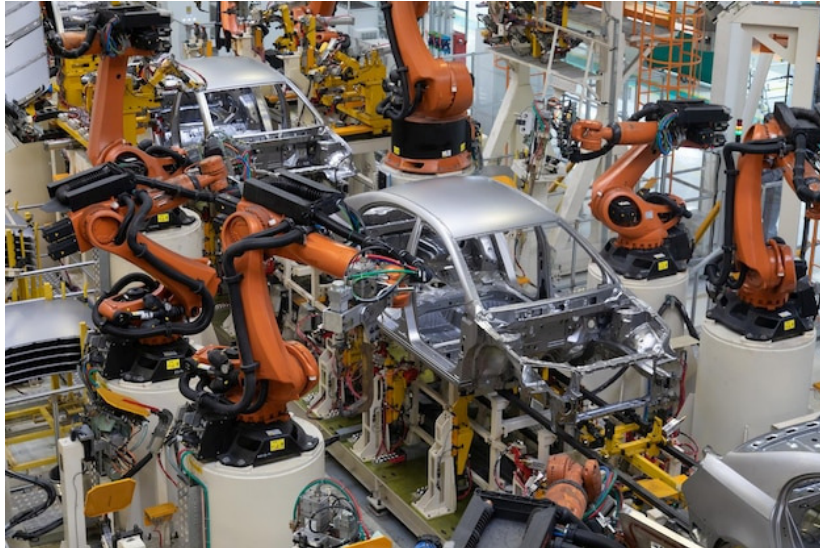
Fig. 1.4 L'industrie automobile avec l'utilisation de robots industriels pour effectuer l'assemblage et la peinture des carrosseries
