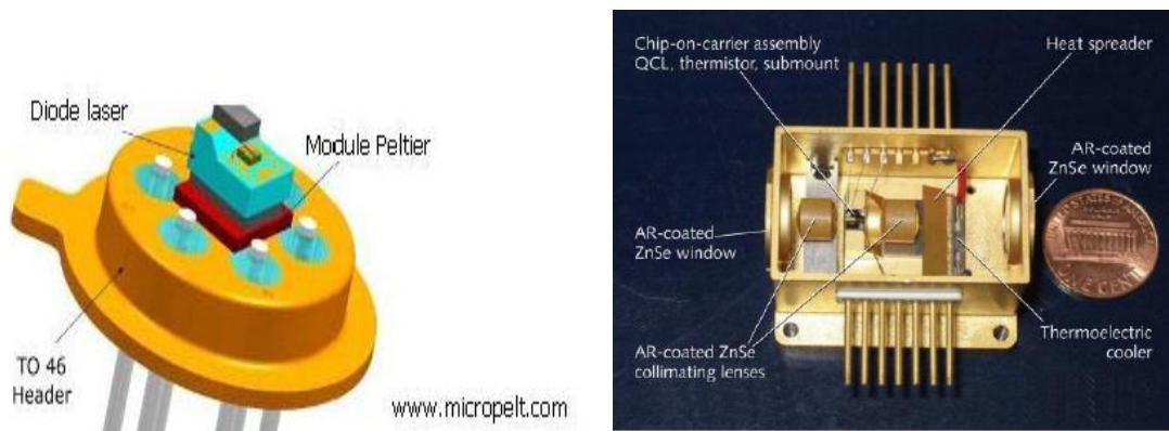
Figure 1 : Applications de refroidissement à base de modules thermoélectriques d'une diode laser [7]
