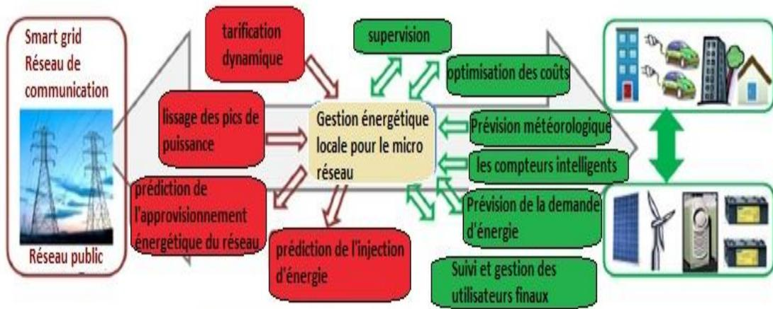
**Figure (I.6):** Principe d'interface pour la gestion de l'alimentation
