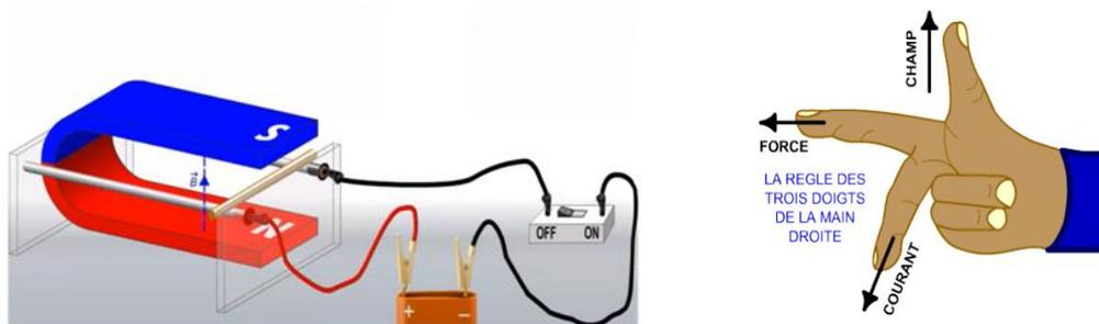
Figure (III.08) : Représentation de la force de Laplace
