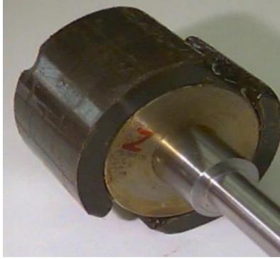
Figure (V.04) : Rotor à aimant permanent (MSAP)
