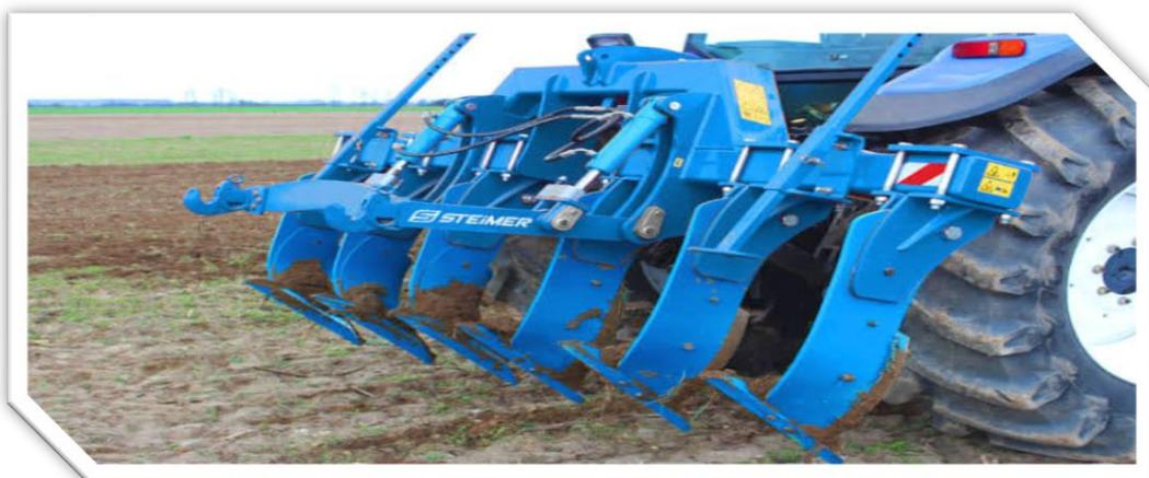
Figure ; Le sous-solage :est une technique agricole de travail du sol en profondeur, permettant de lui redonner de la perméabilité en améliorant le drainage naturel et la circulation capillaire horizontale de l'eau sur les sols labourés ou compactés
