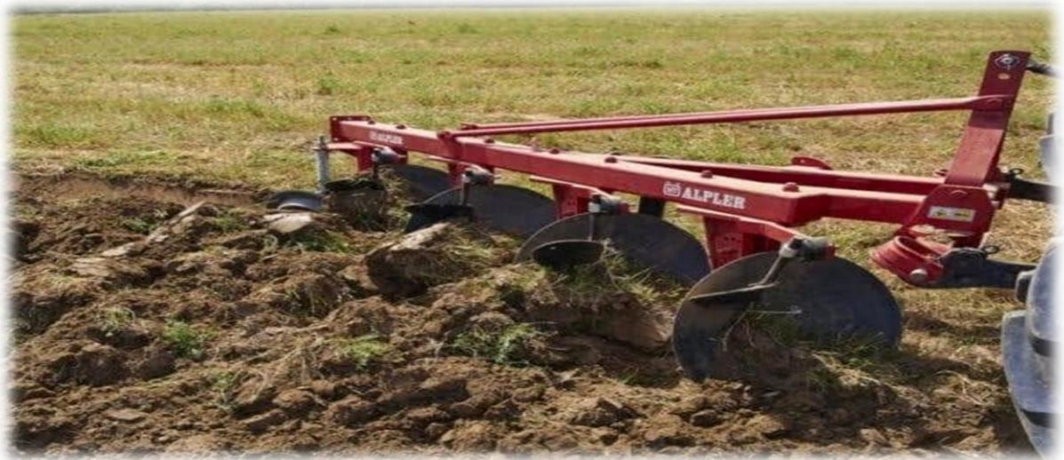
Figure charrue à disque: est plus adaptée aux conditions difficiles sols à racines, à pierres et ou à graviers
