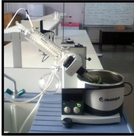
Figure 34. L'évaporateur rotatif de type Heidolph G1.
