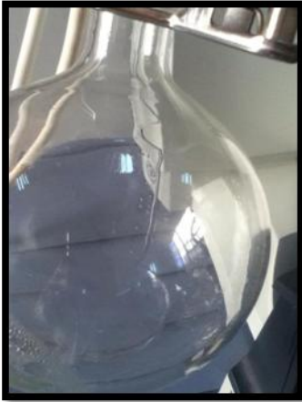
Figure 33. La récupération du solvant (eau, éthanol ou méthanol) dans le ballon réceptacle.
