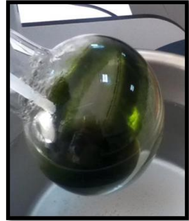
Figure 35. La concentration à sec du filtrat (évaporation progressive et totale du solvant).
