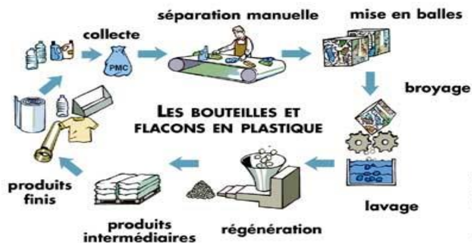
Figure 18 : Transformation des bouteilles de plastique en flocons « granules »
