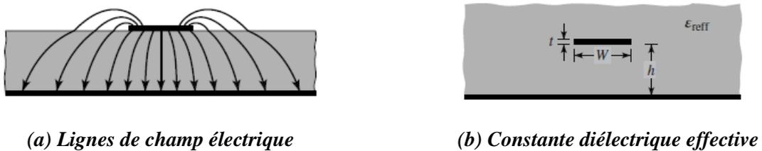
Figure II.15: Lignes de champ électrique et géométrie de constante diélectrique effective.
