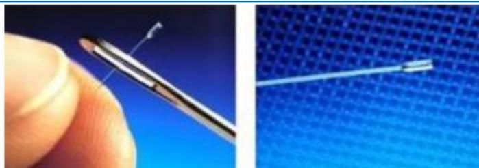
**Figure 3.12 :** Capteur pour mesurer la pression dans les vaisseaux sanguins.
