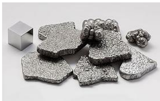
Figure 3.7 : Fragments purs (à plus de 99,97 %) de fer
