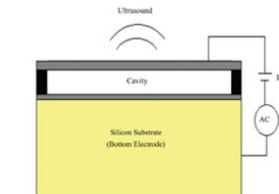
FIGURE 2.7 – Transducteur à ultrasons capacitif micro-usiné [102]
