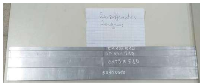
Figure 5. 7. Différentes éprouvettes de coté largeurs
