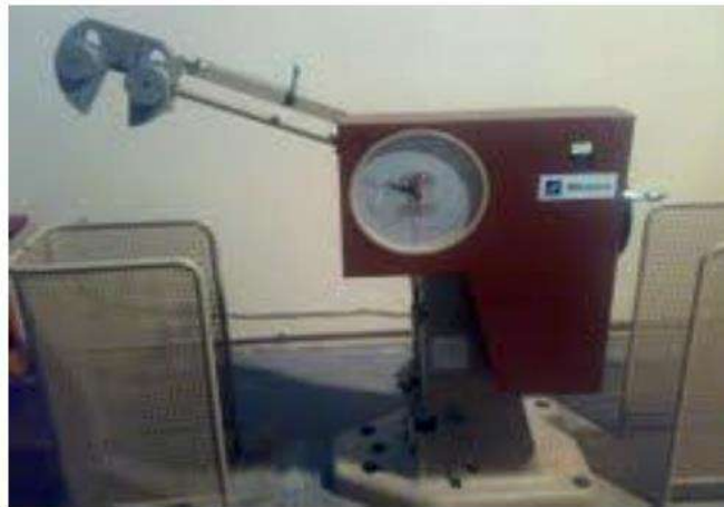
Figure 7.2. Machine de résilience
