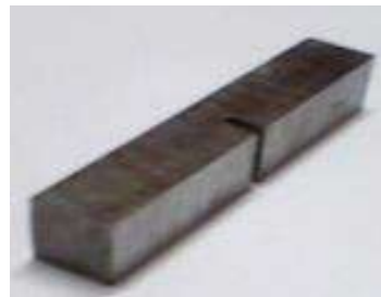
Figure 7.4. Éprouvette de résilience utilisée
