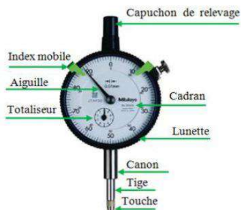
Figure 2.12 Composantes d'un comparateur
