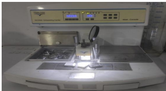
Figure 69. Station d'enrobage Histo-Line TEC 2900 pour l'inclusion en paraffine.
