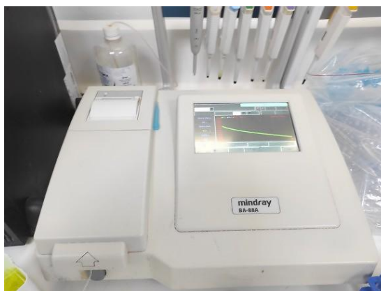
Figure 64. Spectrophotomètre semi-automatique BA-88A (Mindray, Shenzhen, Chine) utilisé pour les dosages biochimiques.
