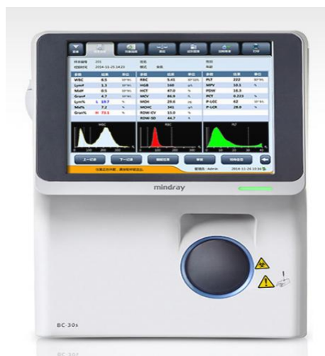
Figure 65. Analyseur automatique d'hématologie à trois parties BC-30S (Mindray, Shenzhen, Chine) utilisé pour l'évaluation des paramètres sanguins.
