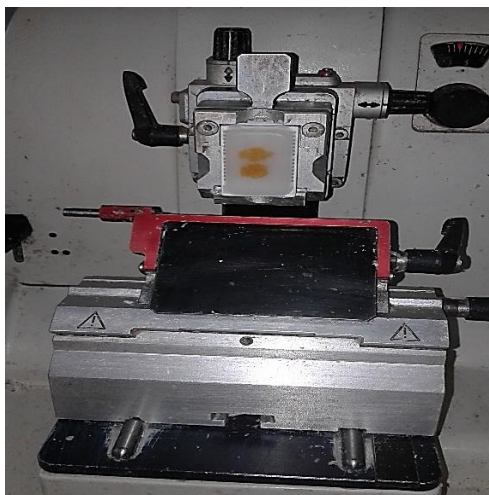
Figure 71. Mise en place du bloc de paraffine dans le microtome avant la coupe
