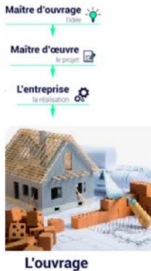
Figure I.1 : Schéma des intervenants en construction
