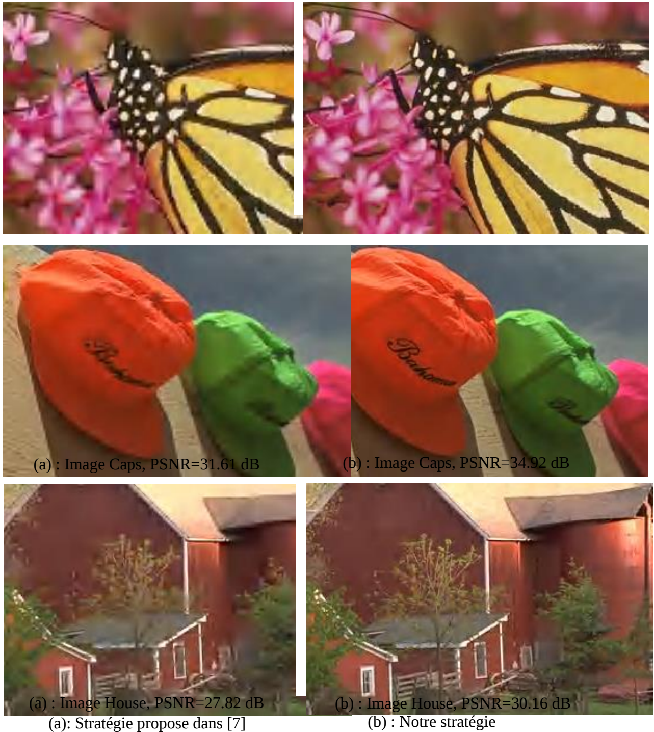
Figure 3.17 : Comparaison visuelle pour la transmission des images en couleur.
