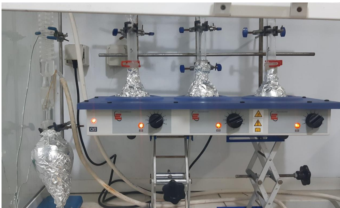
Figure 21: Montage d'un hydrodistillateur (Photo Originale).
