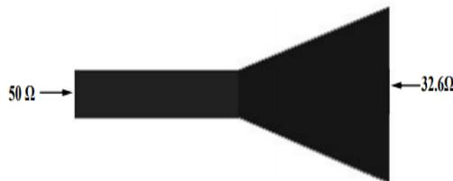
Figure III.64: Présentation du taper fonctionnant dans la bande Ku sous Momentum.
