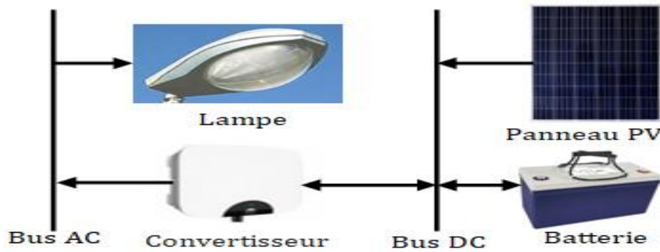
Figure II.4. Schéma d'un système d'éclairage public photovoltaïque.
