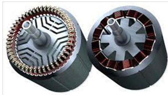
Figure 1.9 : Moteur à réluctance variable MRV [25]
