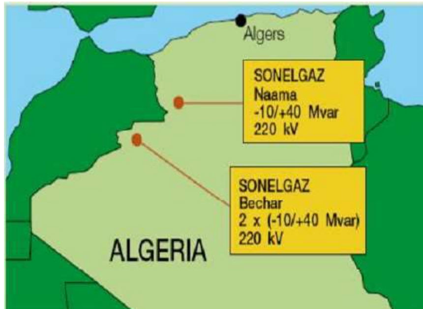
Fig.V.21. Systèmes FACTSs en Algérie : un SVC à Naama et deux SVCs à Béchar [Ker- 17].
