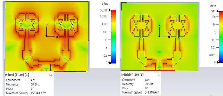
Figure IV.19 : Distribution du champ électrique E et magnétique H à 30 GHz
