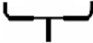
Figure II.15 : Diviseur d'impédance en technologie microruban.
