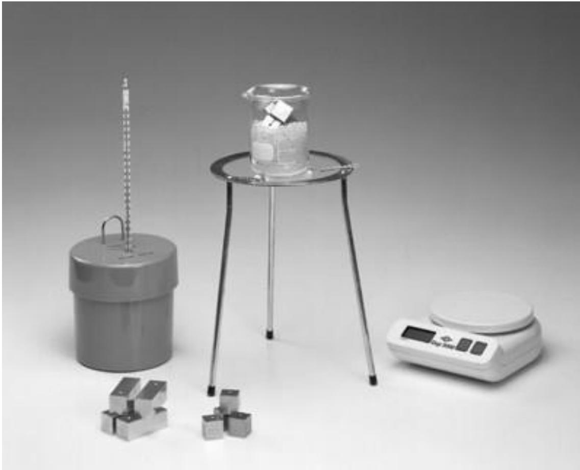
FIGURE 2.1 – Dispositif de détermination de la chaleur spécifique de solides.
