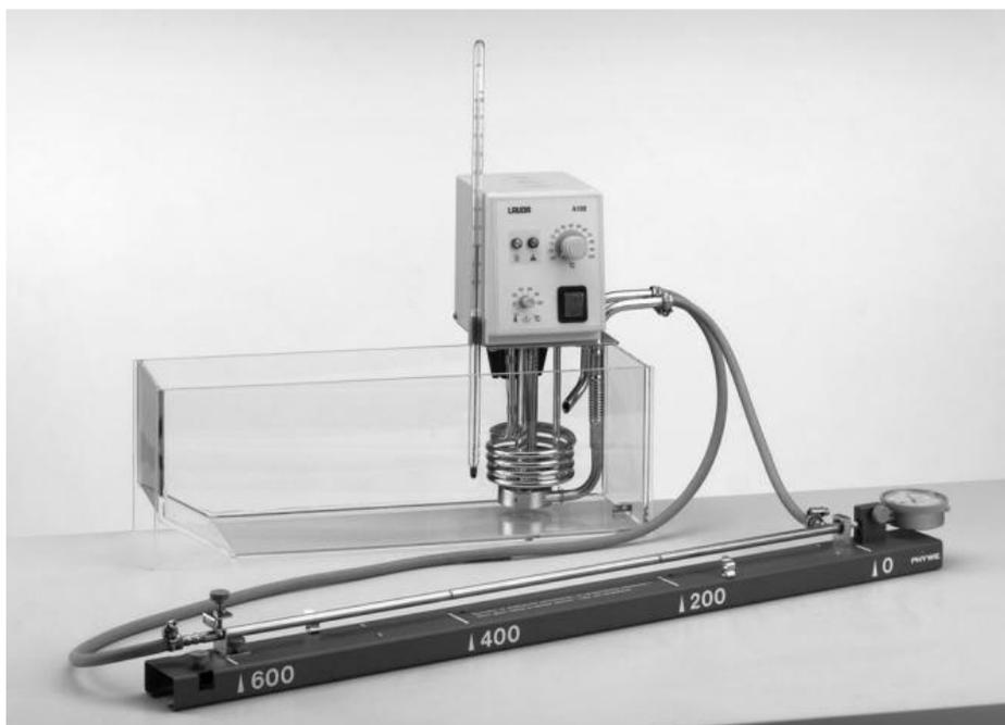
Figure 5.1 – Dispositif servant à l'étude de la dilatation linéaire des solides.
