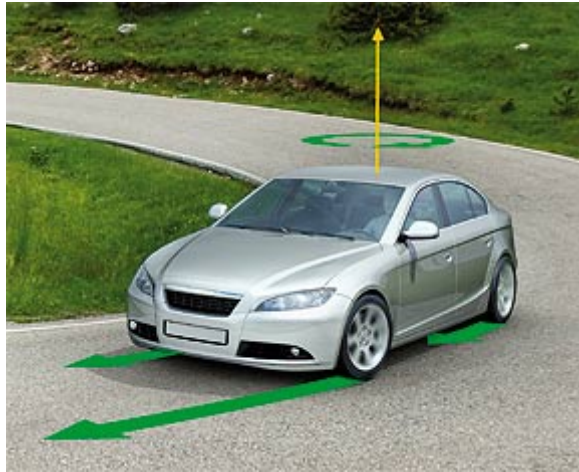
Figure 5. 17 : Moment de lacet résultant entre les roues gauches et droites
