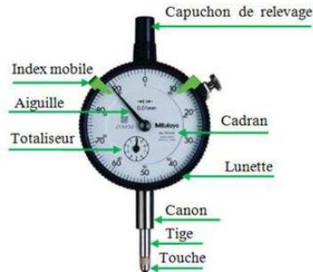
Figure 4.29. Composantes d'un comparateur
