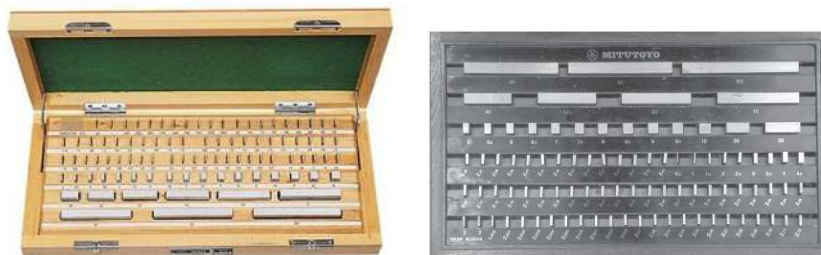
Figure 4.36. Cales étalons pour la vérification des longueurs
