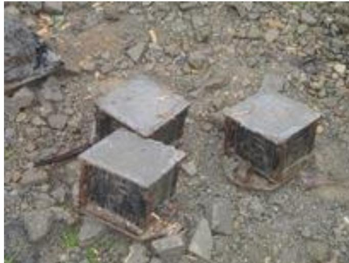
**Fig I.2 Eprouvettes cubiques, (source : pseau.org).**
