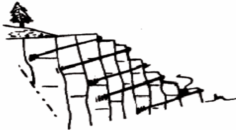
Figure III.30: Stabilisation des talus par boulonnage (CHARLES, 2009)
