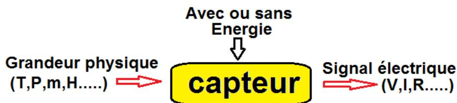
*Figure I.1. schéma de base de conversion de grandeur non électrique par un capteur.*
