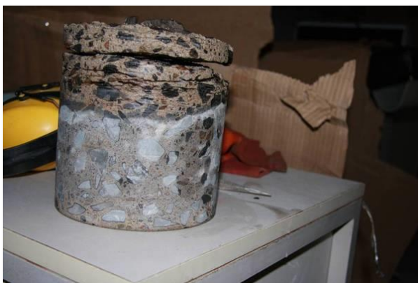
Figure 2.18. Sulfatation du béton [7]
